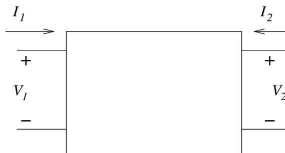
Figura 2.6: Modelado de una línea de transmisión como bipuerto
